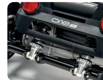
Schokdempers op de wielen en vering onderaan de stoel zorgen voor een aangenaam rijgevoel.
